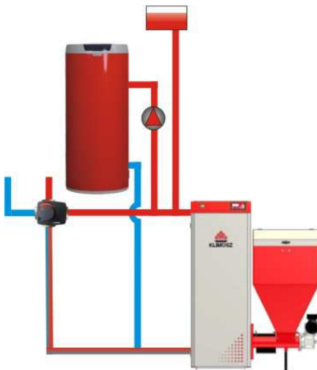
Rys. 12. Układ ogrzewania w trybie LATO – tylko c.w.u..
