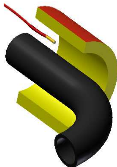
Rys. 9. Montaż czujników temperatury
