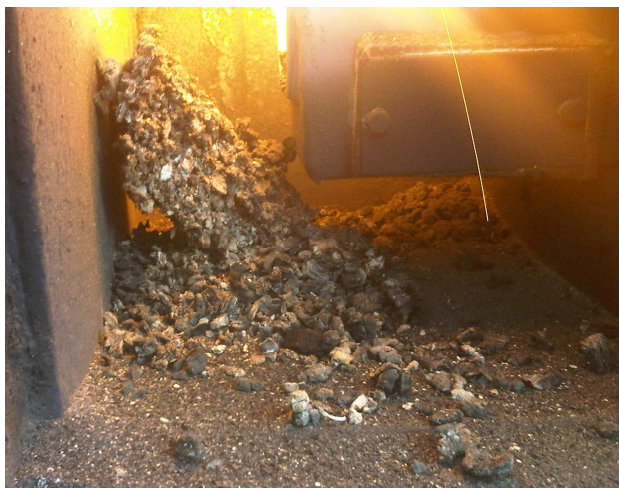
Rys. 21. Żużlowanie węgla – niepoprawna regulacja palnika względem jakości paliwa.
