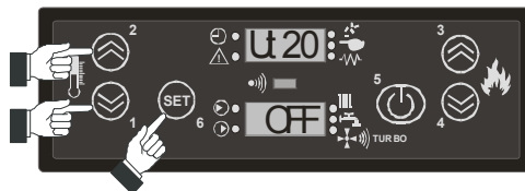
Włączenie zewnętrznego termostatu, a w konsekwencji wyłączenie termostatu wewnętrznego.
