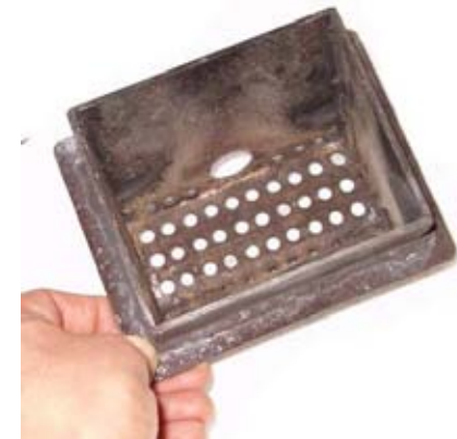
Rysunek 2 – Przykład czystego rusztu
