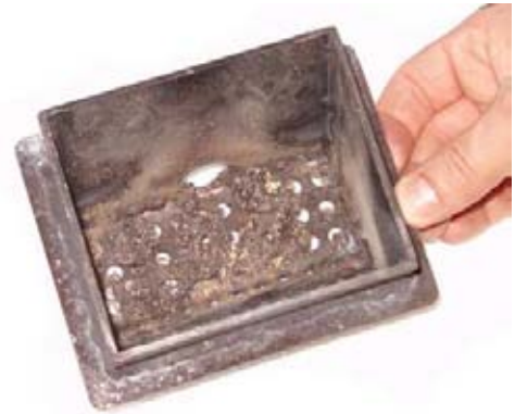
Rysunek 1 – Przykład brudnego rusztu
