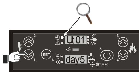
Wybór bieżącego dnia i uaktywnienie trybu PROGRAMOWANY.
