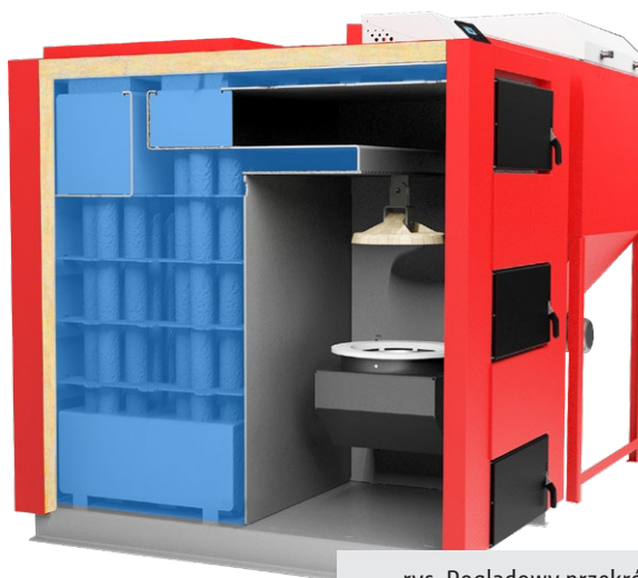
rys. Poglądowy przekrój kotła MAXI
