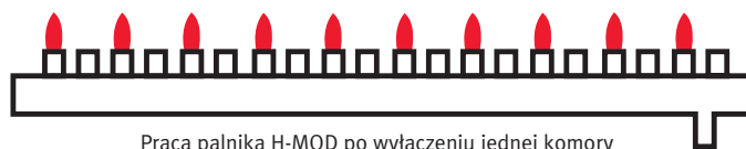
Praca palnika H-MOD po wyłączeniu jednej komory
