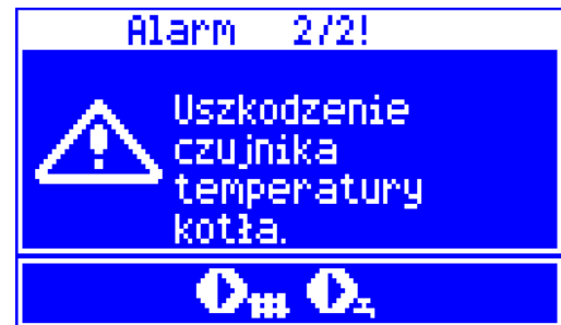
Rys. 45 Widok alarmu „uszkodzenie czujnika temperatury kotła”.
