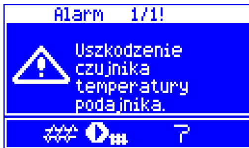
Rys. 46 Widok alarmu „uszkodzenie czujnika temperatury podajnika”.
