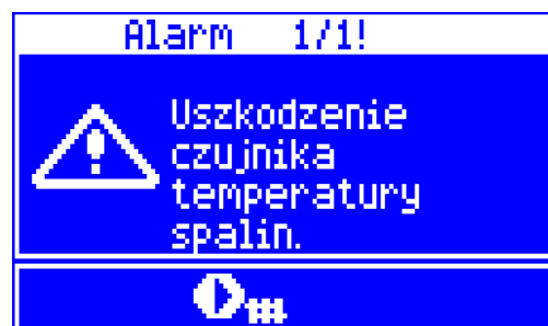
Rys. 43 Widok alarmu uszkodzenia czujnika spalin
